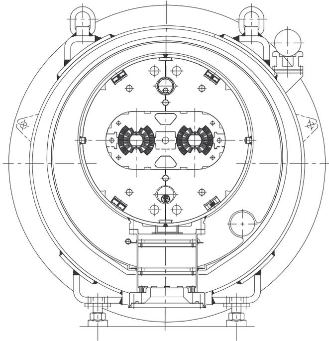
Fig. 2 LHC dipole
